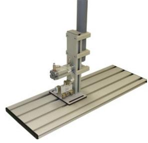
Комплект «Основы мехатроники» предназначен для изучения структуры, принципов построения и основной элементной базы автоматических линий и мехатронных систем. Комплект представляет собой набор из четырех действующих моделей промышленных механизмов с пневматическими и электрическими приводами, а также устройств их ручного и программного управления. Каждый из четырех механизмов может работать как самостоятельно, так и быть встроенным в производственную линию с другими механизмами.
